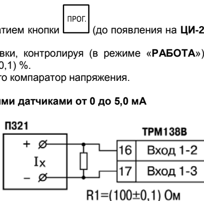
Рисунок Д.6 – Схема подключения магазина сопротивлений при юстировке
