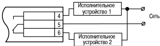
Рисунок 5.3 – Схема подключения нагрузки к ВУ типа Р
