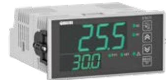
УЗС1 Цифровой задатчик сигналов 4...20 мА и 0...10 В
