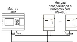
Рисунок 14 – Типовая схема подключения в режиме Master
