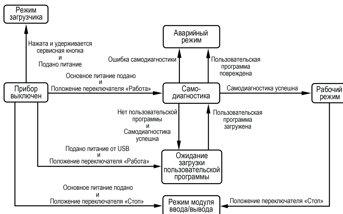
Рисунок 7.7 – Схема переходов между режимами работы
