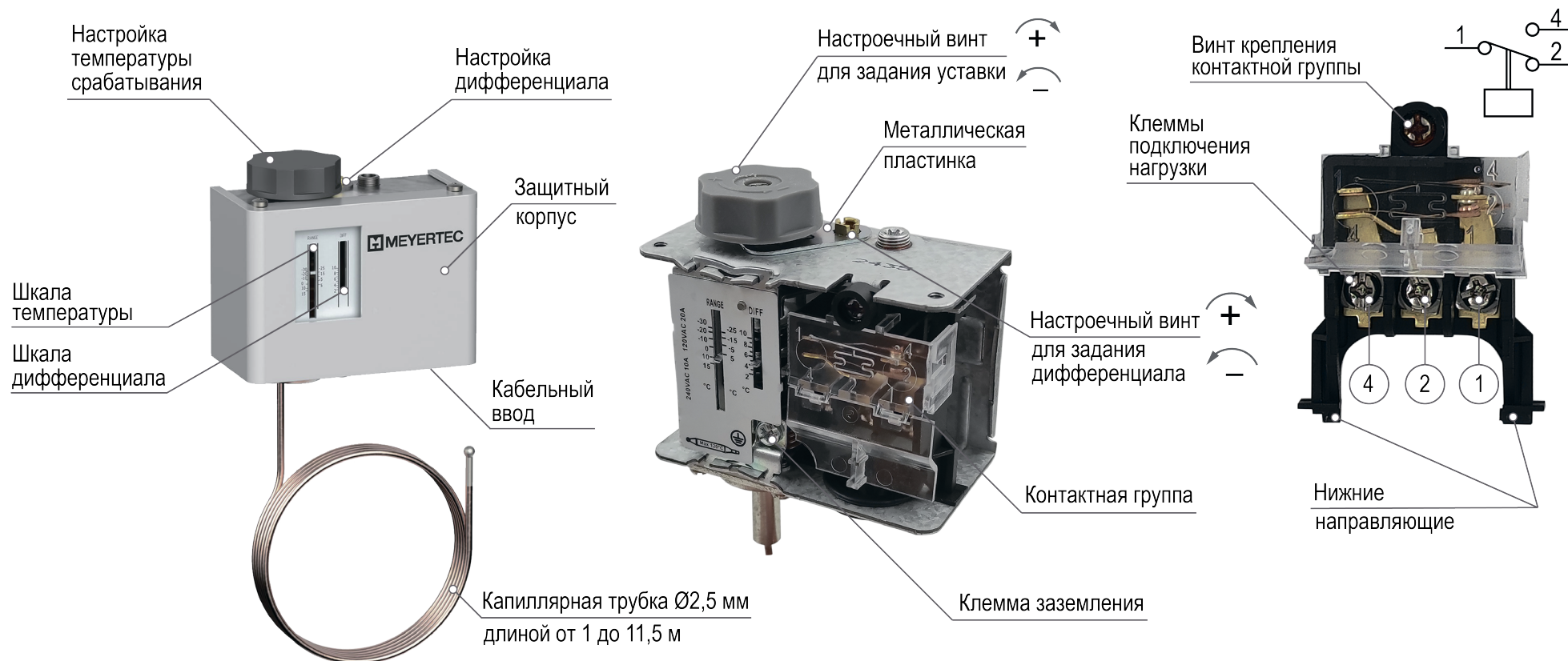
Рисунок 4.1 – Конструкция прибора
