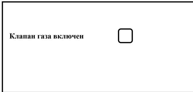
Квадратный индикатор (справа от надписи) показывает наличие или отсутствие команды включения клапана – клапан включен, если индикатор залит темным цветом
