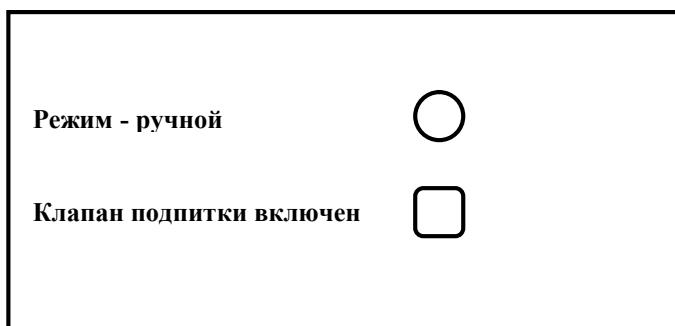
Круглый индикатор «Режим - ручной» показывает статус режима клапана подпитки – клапан в режиме местного управления, если индикатор залит темным цветом
