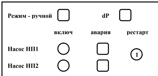
Квадратный индикатор «Режим - ручной» показывает статус режима насосов – насосы в режиме местного управления, если индикатор залит темным цветом
