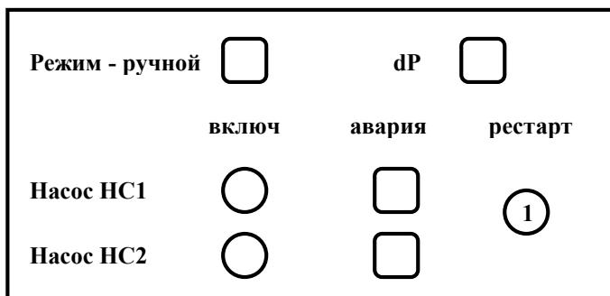
Квадратный индикатор «Режим - ручной» показывает статус режима насосов – насосы в режиме местного управления, если индикатор залит темным цветом
