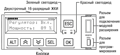
Рисунок 7 – Лицевая панель прибора (крышка отсека подключения модулей условно не показана)
