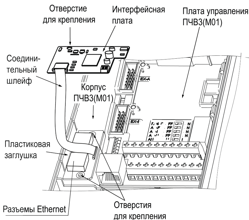
Рисунок 7.40 – Монтаж платы на преобразователях частоты мощностью 5,5 – 45 кВт
