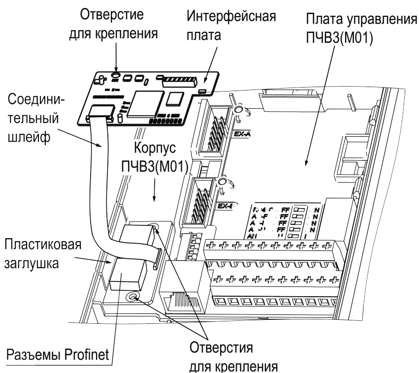
Рисунок 7.34 – Монтаж платы на преобразователях частоты мощностью 5,5 – 45 кВт
