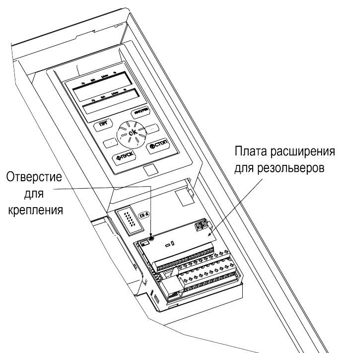
Рисунок 7.45 – Монтаж платы расширения для резольверов
