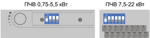
Рисунок 6.4 – Вид на блок DIP-переключателей
