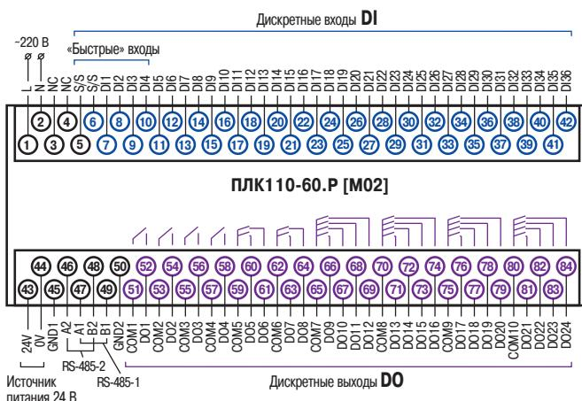
Схема расположения и назначение клемм
