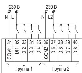
Подключение дискретных датчиков с питанием ~230 В
