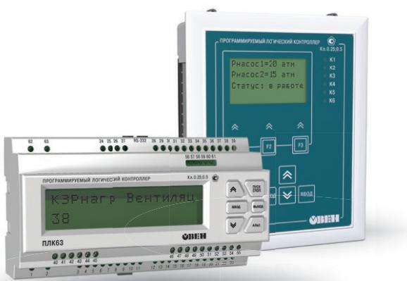
Для построения локальных систем управления и «законченных» масштабируемых решений: в системах HVAC, сфере ЖКХ (ИТП, ЦТП), АСУ водоканалов, для управления малыми станками и механизмами, пищеперерабатывающими и упаковочными аппаратами, климатическим оборудованием, для автоматизации торгового оборудования.
