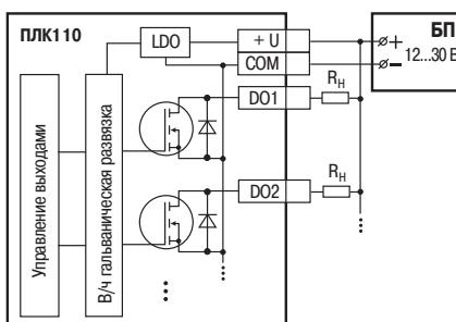
Схема подключения выходных элементов типа K (быстро действующих)
