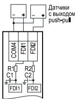
Подключение к дискретным вх. типа «ДС» датчиков с выходом push-pull
