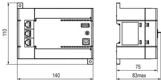
Габаритный чертеж корпуса ПЛК110-30[М02], ПЛК110-32[М02]
