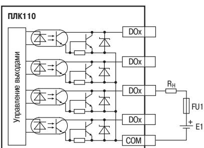
Схема подключения выходных элементов типа K (обычных)
