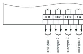
Схема подключения нагрузки к ВЭ типа «Р»
