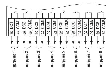
Подключение нагрузки к выходным элементам (В3) типа Р
