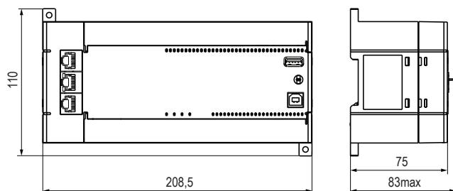
Габаритный чертеж корпуса ПЛК160[М02], ПЛК110-60[М02]
