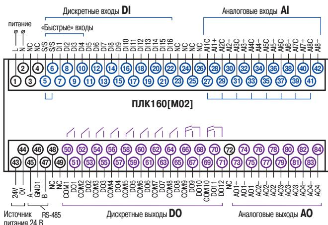
Схема расположения и назначение клемм
