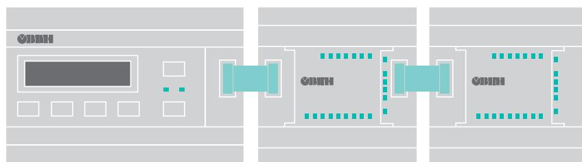
В зависимости от модели количество входов/выходов может быть увеличено подключением модулей расширения – ПРМ. Модули подключаются по внутренней шине. Допускается подключение одного или двух модулей. Подключение осуществляется шлейфом, идущим в комплекте с ПРМ. Добавление модулей в Owen Logic производится простым выбором из списка подключаемого модуля. После этого дополнительные входы и выходы появляются на основном холсте программы пользователя.
