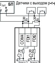
Подключение к вх. типа «ДС» датчиков с выходом п-п-п
