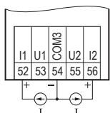
Подключение активных датчиков с выходом типа «Ток 4...20 мА»
