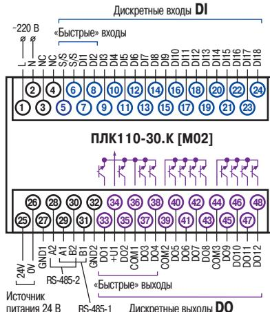
Схема расположения и назначение клемм
