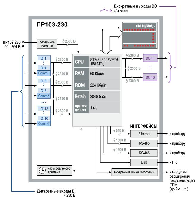
Предназначено для управления отоплением, вентиляцией, насосными группами и т.д. Наличие интерфейса Ethernet расширяет коммуникационные возможности прибора. Доступ к OwenCloud осуществляется напрямую.
