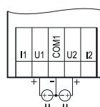
Подключение датчиков с выходом в виде напряжения
