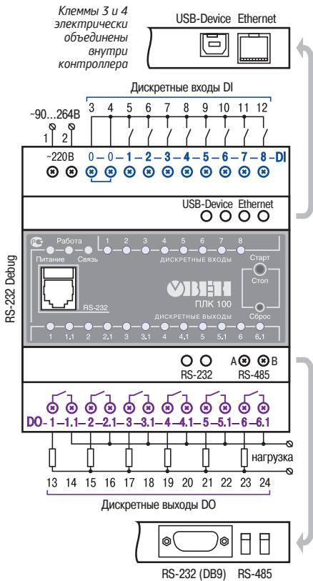
Схема подключения ПЛК100-24.K
