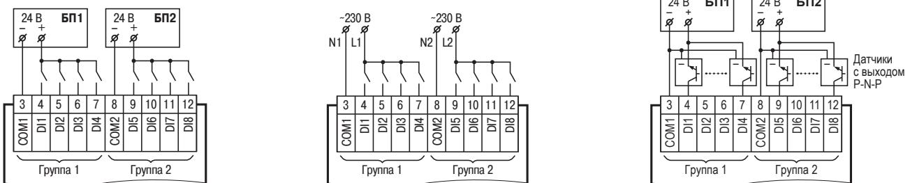
Подключение дискретных датчиков =24 В
