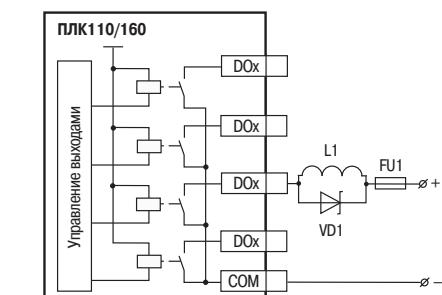
Подключение цепей защиты при реактивной нагрузке
