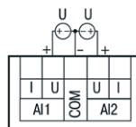
Подключение датчиков с выходом
