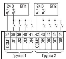
Подключение дискретных датчиков с питанием =24 В
