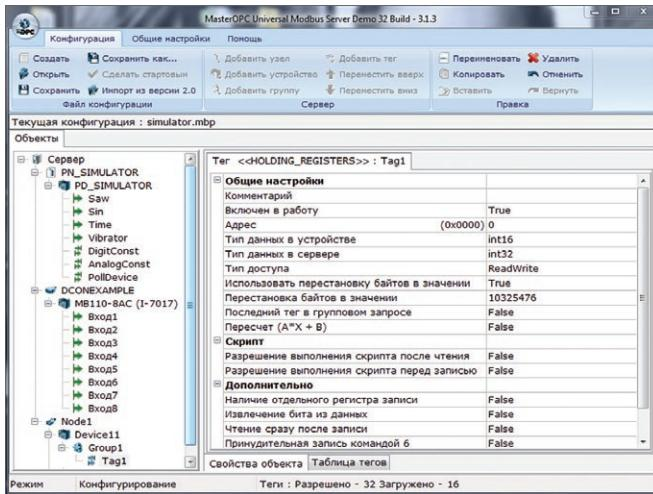
Данный OPC-сервер работает по протоколам Modbus RTU, Modbus ASCII и Modbus TCP. MasterOPC реализует две технологии OPC-интерфейсов: DA (Data Access – текущие данные) и HDA (Historical Data Access – архивные данные). Для организации хранения архивов опрашиваемых переменных MasterOPC использует встроенный SQL-сервер.
