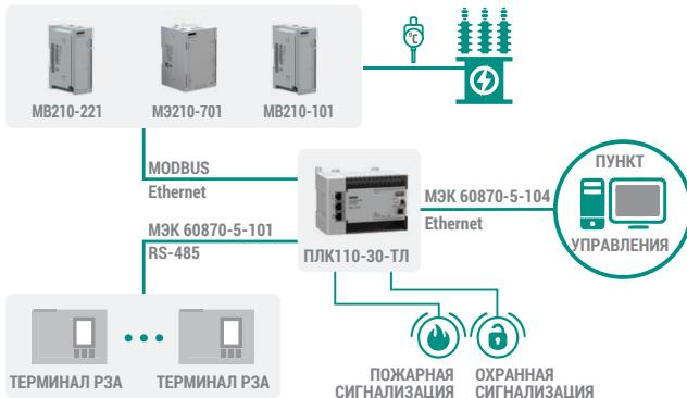
Система телемеханики распределительной трансформаторной подстанции РТП 35/6(10) кВ
