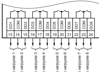
Подключение нагрузки к ВЭ типа Р –
