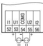
Подключение активных датчиков с выходом типа «Напряжение 0...10 В»
