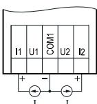
Подключение датчиков с выходом в виде тока
