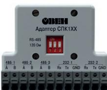
**Адаптер СПК1XX** – переходник с разъемами DB9 на пружинные зажимные клеммы.
