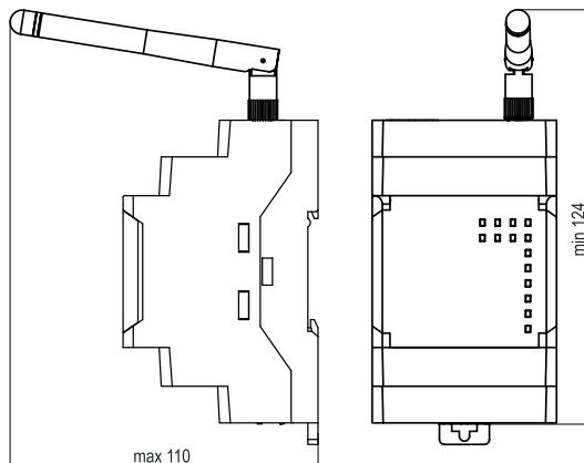
Габаритные размеры Px210 с антенной
