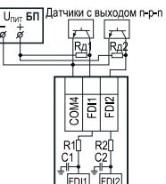
Подключение к вх. типа «ДС» датчиков с выходом п-п-н
