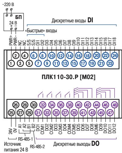
Схема расположения и назначение клемм
