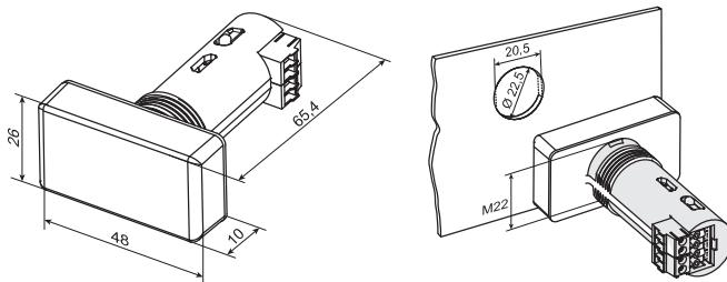
Трёхцветный Modbus-индикатор для отображения одного параметра. Имеет яркий светодиодный дисплей.
