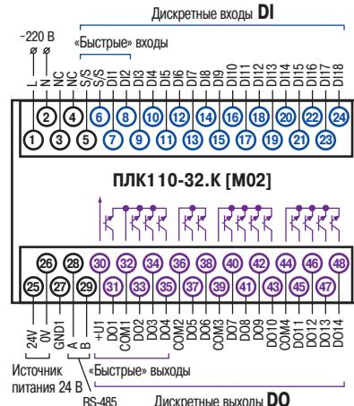
Схема расположения и назначение клемм
