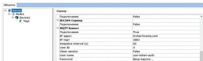
**Multi-Protocol Master OPC Server** – это модульный OPC-сервер, предоставляющий возможности опроса устройств по различным протоколам (BACNet, Profinet, SNMP, счетчики энергоресурсов и др.). Кроме того, Multi-Protocol MasterOPC Server предоставляет возможность поддержки пользовательских протоколов на языке C++ или на встроенным скриптовом языке. Multi-Protocol MasterOPC Server может работать как OPC UA-сервер, OPC UA-клиент, а также как IEC 60870-5-104-сервер.
