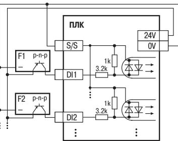
подключение датчиков р-п-р-типа
