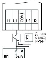
Схема подключения к универсальным вх., работающим в дискретном режиме, трехпроводных дискретных датчиков, имеющих выходной транзистор р-п-р-типа с открытым коллектором
