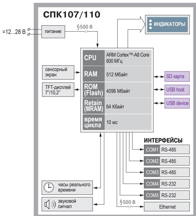
Линейка устройств, объединяющих функции программируемого контроллера и панели оператора в одном корпусе (ПЛК+HMI). Обновленные СПК1xx с Ethernet имеют новую аппаратную и программную платформу, расширенный набор интерфейсов.
