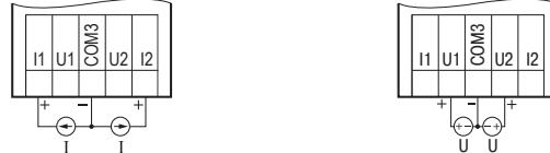
Подключение активных датчиков с выходом «Ток 4...20 мА»
