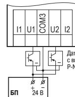
Подключение к универсальным вводам, работающим в дискретном режиме, трехпроводных дискретных датчиков, имеющих выходной транзистор р-п-р-типа с ОК
