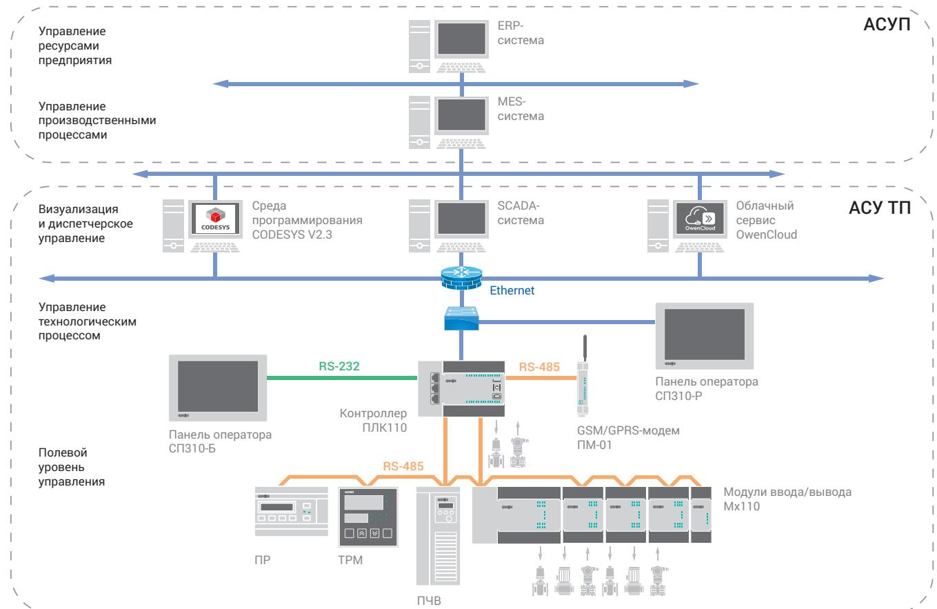
Подключение модулей ввода/вывода и операторской панели
