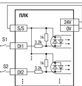
Схема подключения к дискретным входам ПЛК контактных датчиков (S1...Sn)
