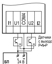
Схема подключения к универсальным
