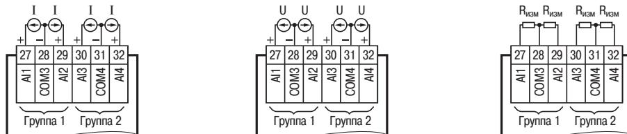
Подключение активных датчиков с выходом «ток 4...20 мА» (встроенное шунтирующее сопротивление  $R_{sh}$ )
