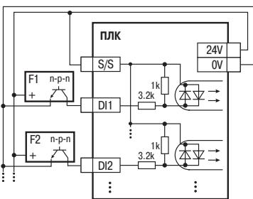
подключение датчиков п-р-п-типа
