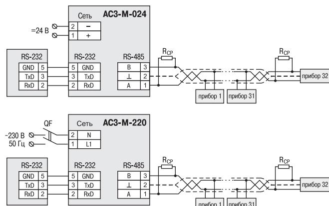
При построении сети с использованием интерфейса связи RS-485 к линии, выполненной витой парой, может быть подключено до 32 приборов, что ограничивается нагрузочной способностью AC3-M. При использовании усилителя сигнала к преобразователю AC3-M можно подключить более 32 приборов (до 247). AC3-M имеет встроенные согласующие резисторы сопротивлением 100 и 120 Ом.
