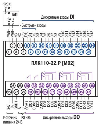
Схема расположения и назначение клемм
