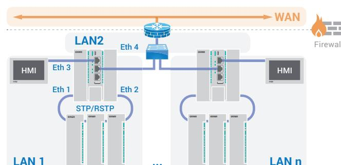
Схема 3. Порты Ethernet 1, Ethernet 2 и Ethernet 3 объединены в мостовое подключение к локальной сети (LAN). Порт Ethernet 4 является отдельным изолированным сетевым интерфейсом для подключения к отдельной локальной сети (LAN).
