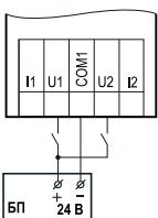
Схема подключения к универсальным вх., работающим в дискретном режиме, датчиков типа «сухой контакт»
