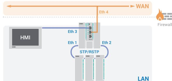
Схема 1. Порты Ethernet 1, Ethernet 2 и Ethernet 3 объединены в мостовое подключение к локальной сети (LAN). Порт Ethernet 4 используется как отдельный изолированный сетевой интерфейс для подключения к глобальной сети (WAN), защищённый межсетевым экраном. Данная схема позволяет разделить сеть на две зоны, обеспечивая одно пространство IP-адресов для портов Ethernet 1–3.
