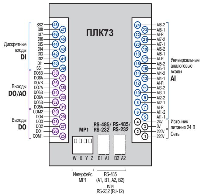
Схема расположения и назначения клемм ПЛК73
