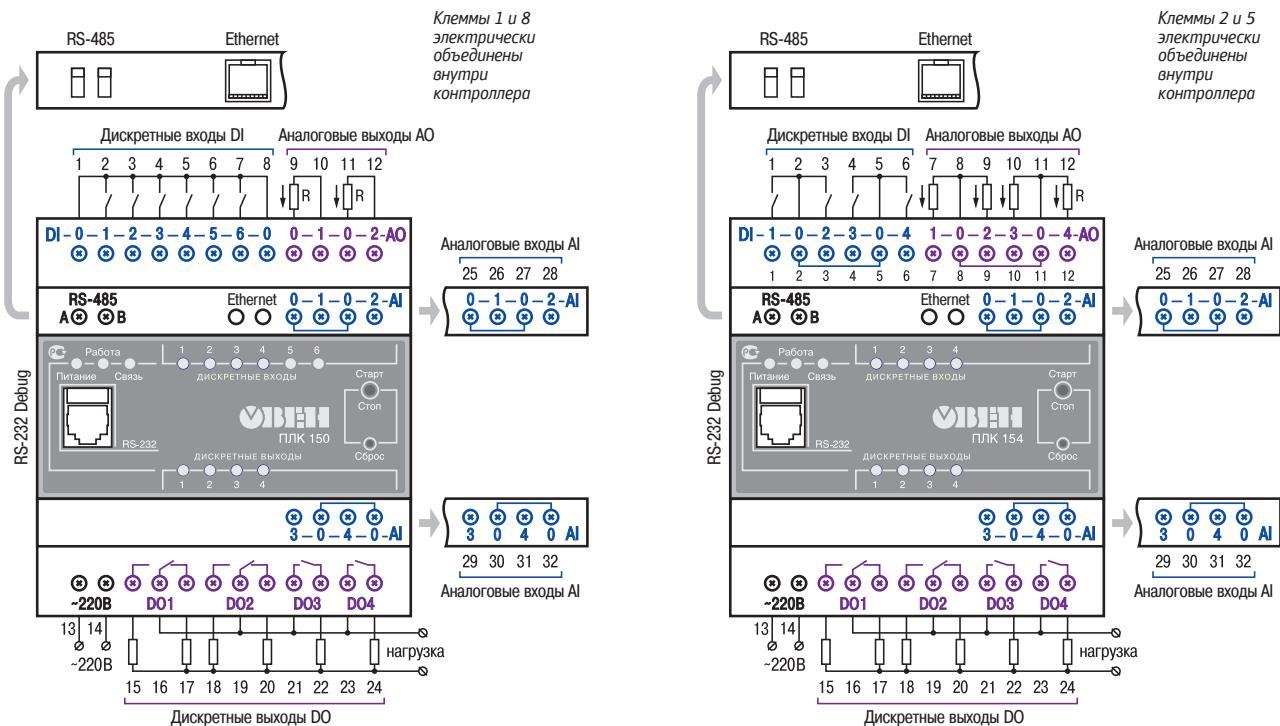
Схема подключения ПЛК150-220
