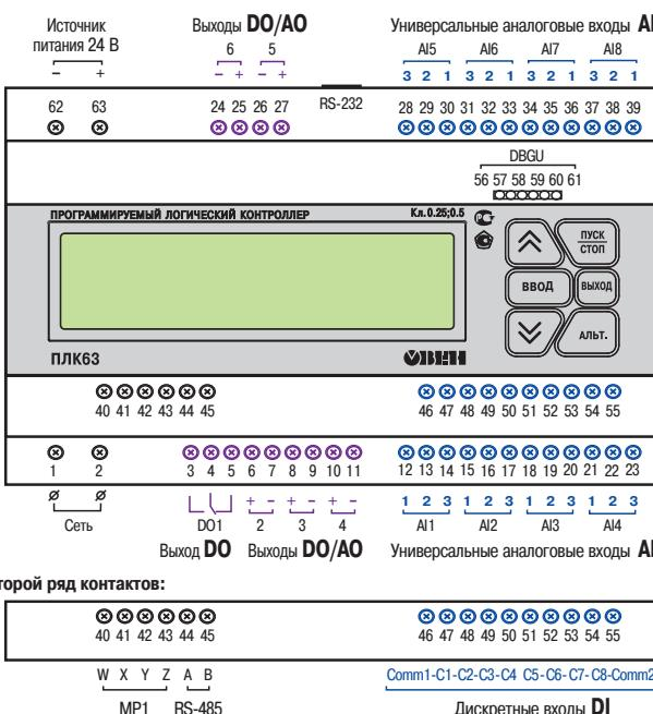
Схема расположения и назначения клемм ПЛК63
