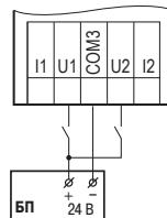
Подключение к универсальным вводам, работающим в дискретном режиме, датчиков типа «сухой контакт»
