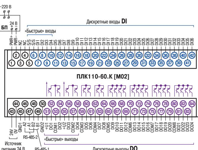
Схема расположения и назначение клемм
