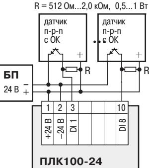
Схема подключения дискретных входов ПЛК100
