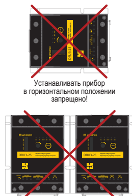
Монтировать приборы вплотную запрещено!
