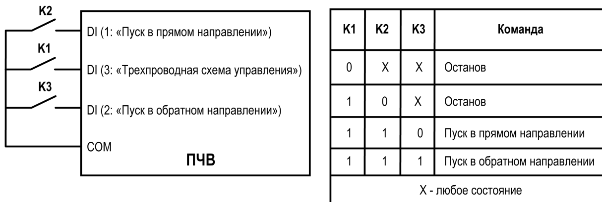
Рисунок 6.4 – Режим управления “Трехпроводная схема 2”
