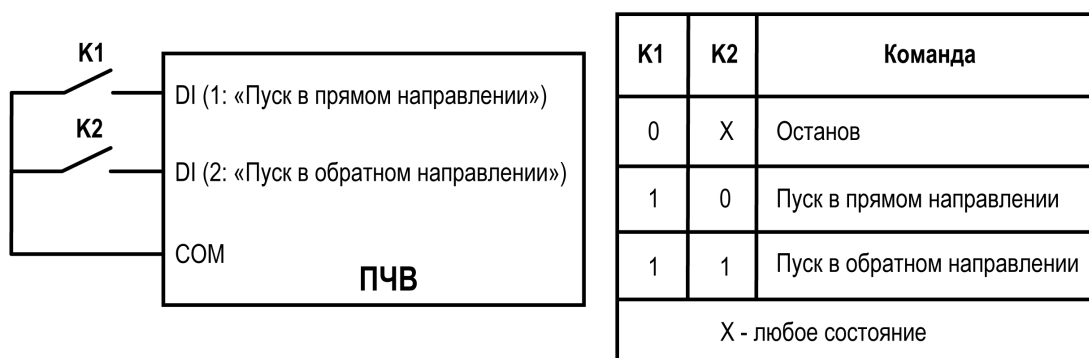
Рисунок 6.2 – Режим управления “Двухпроводная схема 2”
