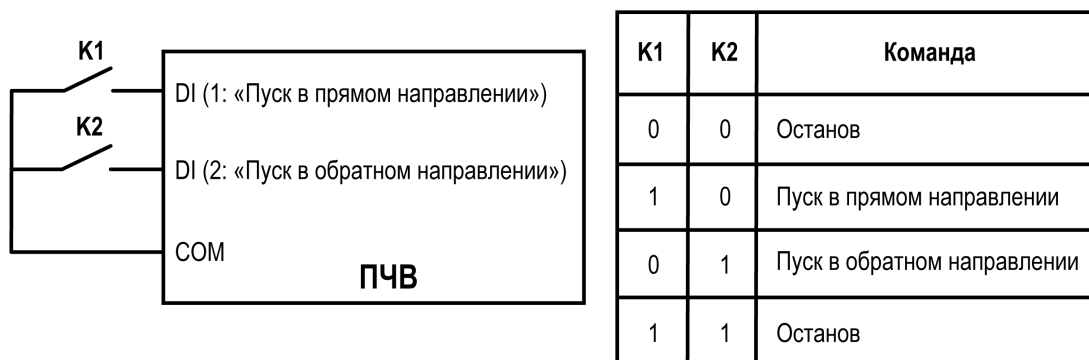
Рисунок 6.1 – Режим управления “Двухпроводная схема 1”
