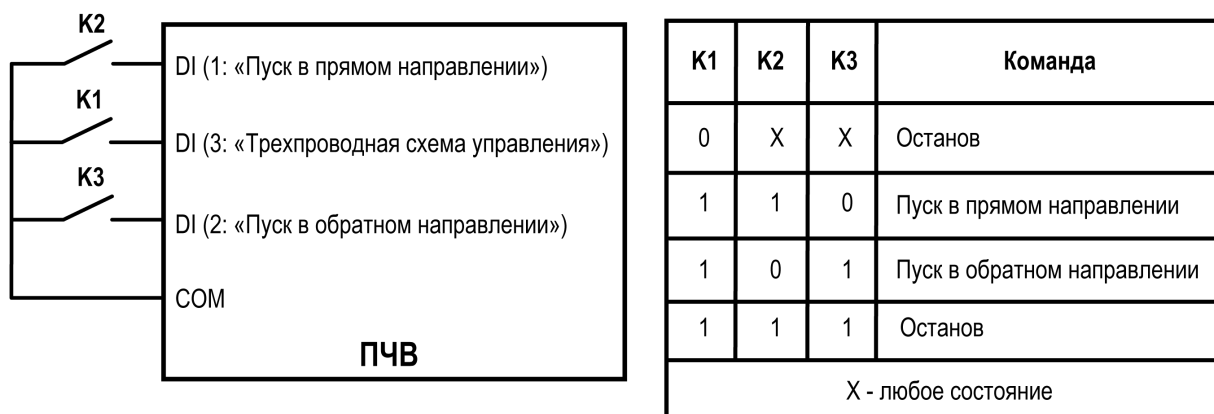
Рисунок 6.3 – Режим управления “Трехпроводная схема 1”
