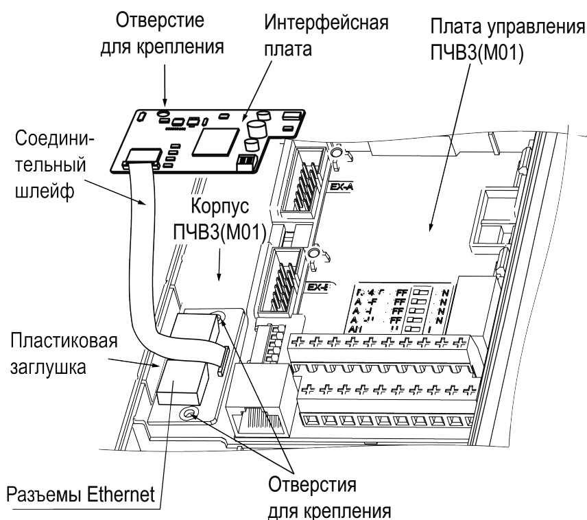
Рисунок 7.40 – Монтаж платы на преобразователях частоты мощностью 5,5 – 45 кВт
