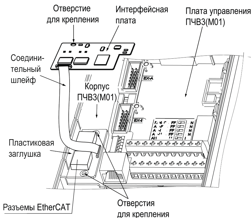
Рисунок 7.37 – Монтаж платы на преобразователях частоты мощностью 5,5 – 45 кВт
