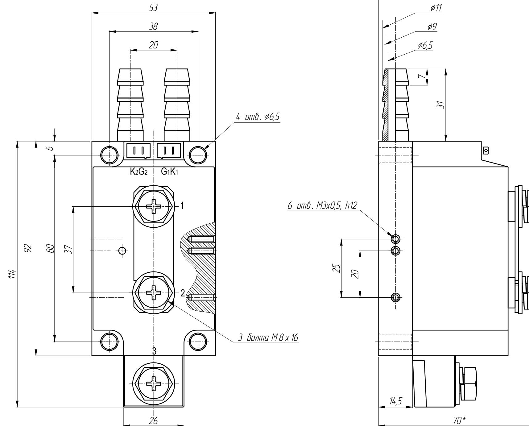
\*Габаритный чертеж корпуса
