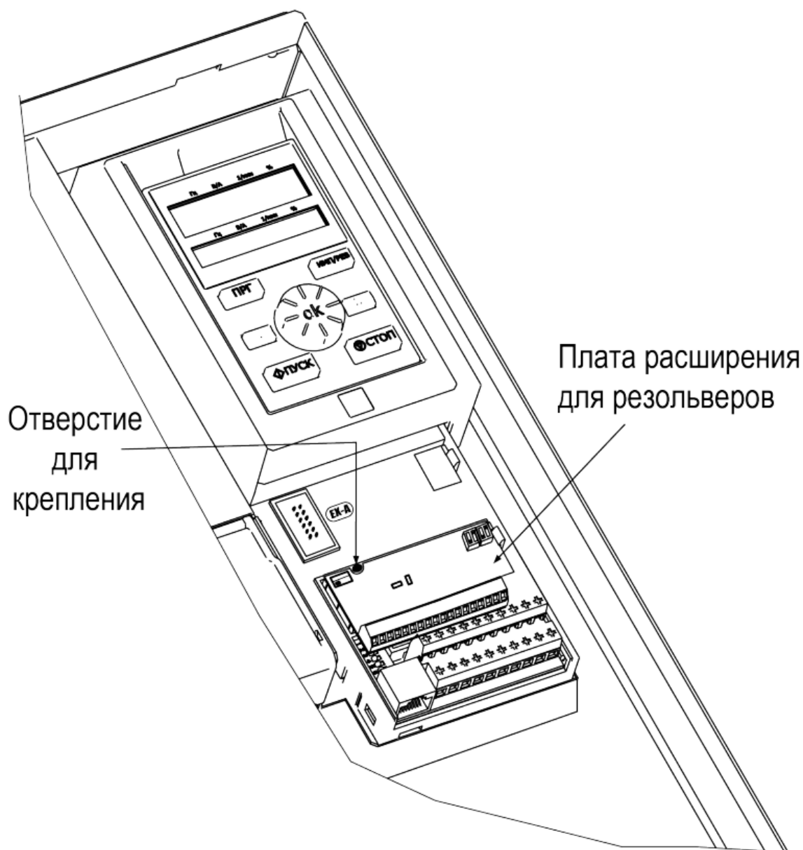
Рисунок 1. Монтаж платы расширения для резольверов
