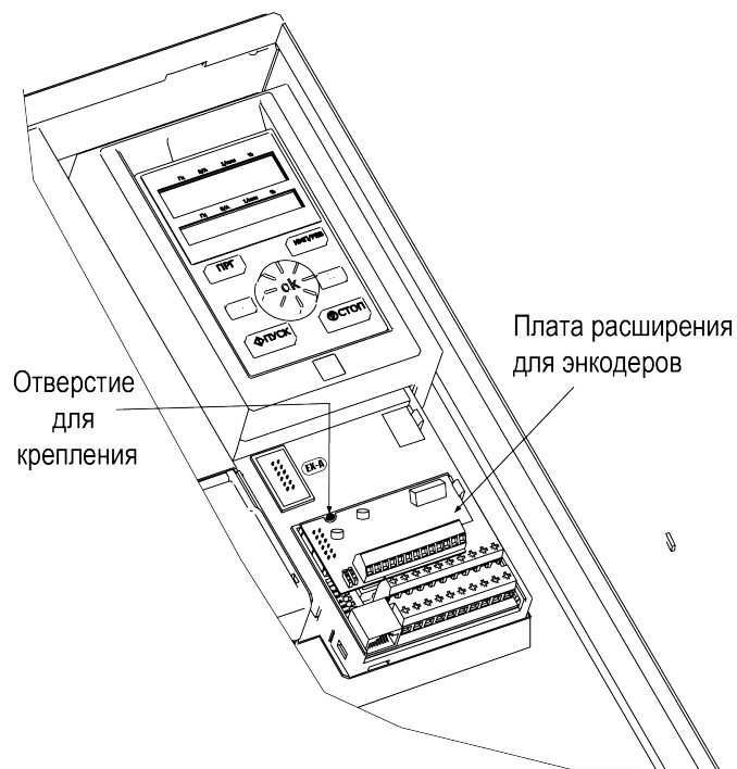
Рисунок 4.1 – Монтаж платы расширения для энкодеров
