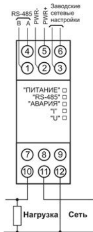
Рисунок Б.1 – Подключение прибора к однофазной сети
