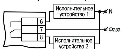
Рисунок 5.7 – Схема подключения нагрузки к ВУ типа «Р»
