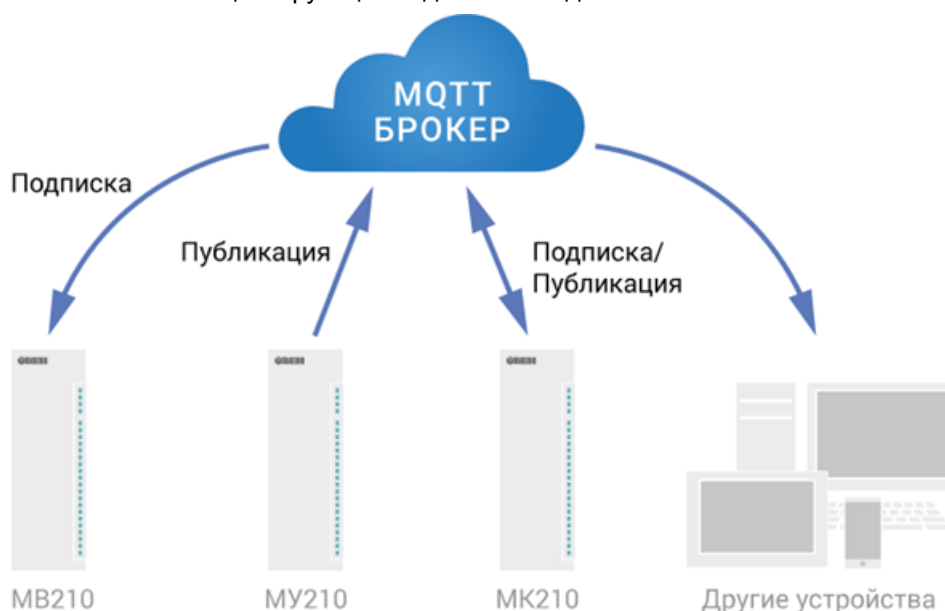
Рисунок 6.5 – Структурная схема обмена по протоколу MQTT
