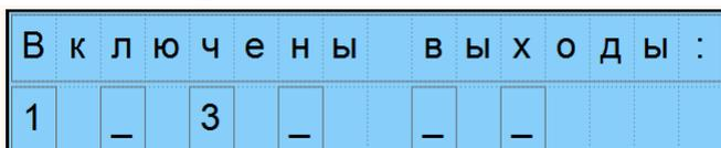
Показано состояние выходов. Если указаны цифры (например, 1 и 3, как на рисунке) значит соответствующий выход находится во включенном состоянии и соответствующая горелка включена. Если указаны прочерки "\_", то соответствующий выход, горелка выключены (например, на рисунке выходы 2,4,5,6 выключены). Если в соответствующей позиции нет символов (ни прочерка "\_" ни цифры), значит соответствующий выход отключен при настройке зон (находится в выключенном состоянии).
