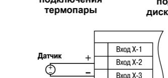
Рисунок 7 – Схема подключения к дискретному входу
