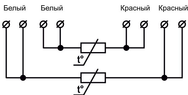
Рисунок Д.6 – Четырехпроводная схема внутренних соединений проводов с двумя ЧЭ
