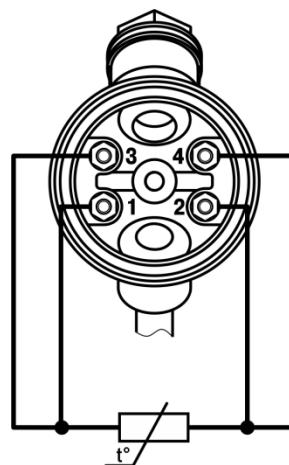
Рисунок Д.10 – Четырехпроводная схема подключения проводов к клеммам пластмассовой коммутационной головки с одним ЧЭ
