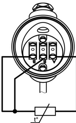
Рисунок Д.12 – Трехпроводная схема подключения проводов к клеммам металлической коммутационной головки с одним ЧЭ
