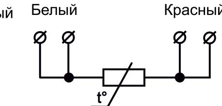
Рисунок Д.3 – Трехпроводная схема внутренних соединений проводов с одним ЧЭ
