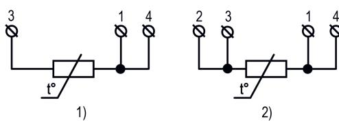
Рисунок Д.7 – Схемы подключения для ДТС205: 1) трехпроводная, 2) четырехпроводная
