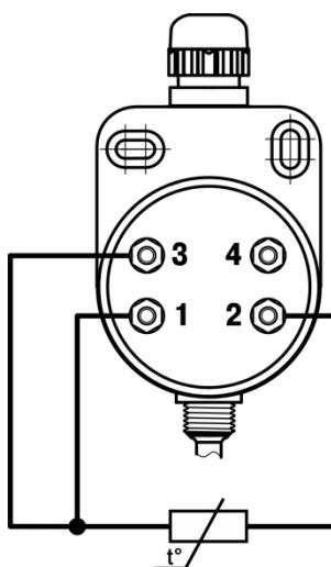
Рисунок Д.18 – Трехпроводная схема подключения проводов к клеммам пластмассовой коммутационной головки ДТС 125Л с одним ЧЭ
