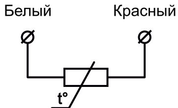
Рисунок Д.1 – Двухпроводная схема внутренних соединений проводов с одним ЧЭ
