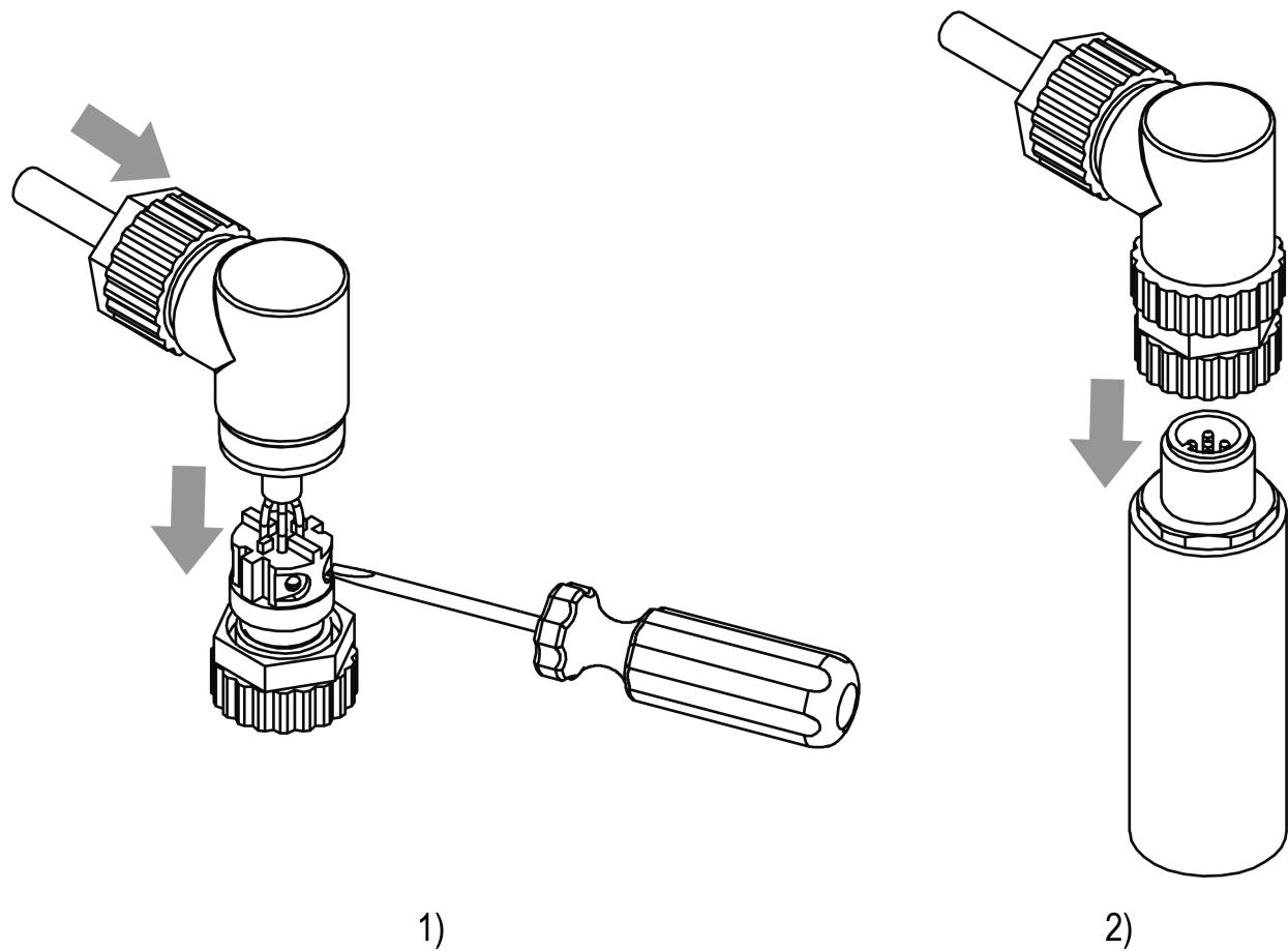
**Рисунок 5.2 – Монтаж проводов**
