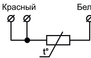
Рисунок Д.2 – Трехпроводная схема внутренних соединений проводов с одним ЧЭ
