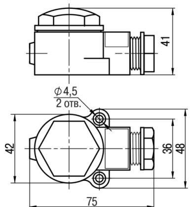
Рисунок Г.4 – Стандартная пластмассовая коммутационная головка
