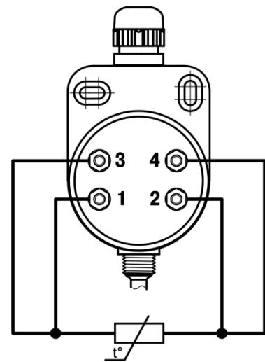
Рисунок Д.19 – Четырехпроводная схема подключения проводов к клеммам пластмассовой коммутационной головки ДТС 125Л с одним ЧЭ
