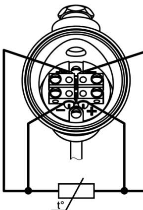
Рисунок Д.13 – Четырехпроводная схема подключения проводов к клеммам металлической коммутационной головки с одним ЧЭ
