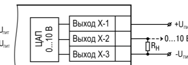
Рисунок 29 – Схема подключения нагрузки к ВУ типа «У»
