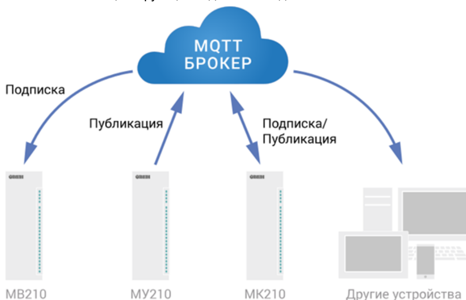
Рисунок 6.2 – Структурная схема обмена по протоколу MQTT
