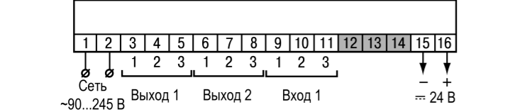
Рисунок 10 – Назначение контактов клеммной колодки прибора в настенном Н и щитовом Щ1, Щ2 типах корпусов
