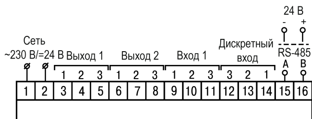
Рисунок 5.7 – Общая схема подключения TRM10–Н
