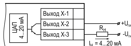
Рисунок 5.22 – Подключение к ВУ типа «И»
