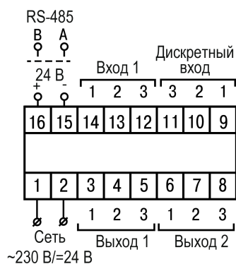
Рисунок 5.5 – Общая схема подключения TRM10–Щ5
