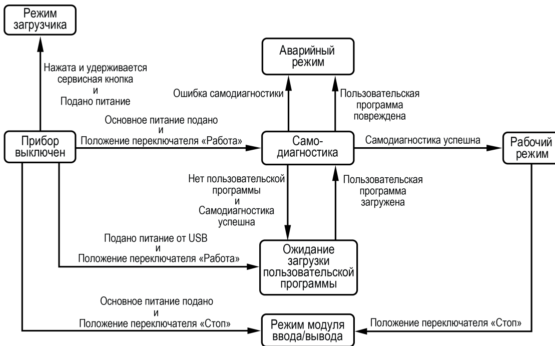
Рисунок 7.4 – Схема переходов между режимами работы
