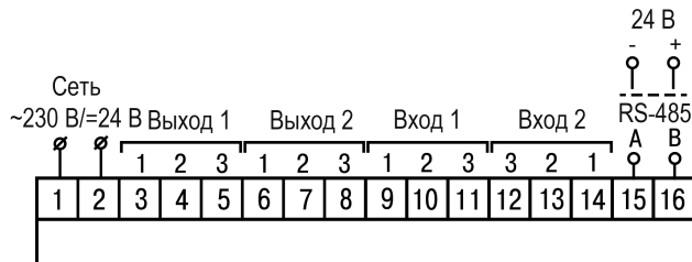
Рисунок 5.7 – Общая схема подключения 2TRM1–Н
