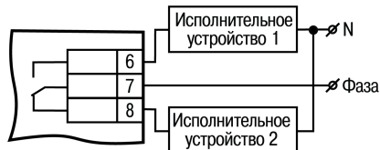
Рисунок 5.7 – Схема подключения нагрузки к ВУ типа «Р»
