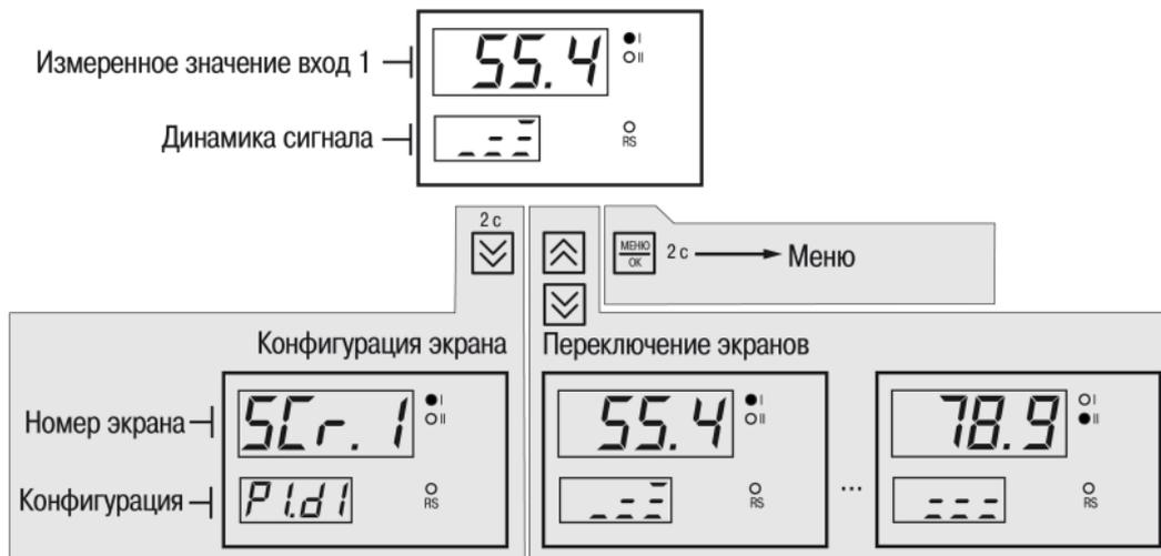
**Рисунок 6.4 – Схема переходов с главного экрана**
