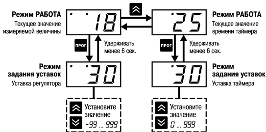
Рисунок 7.1 – Схема задания уставок регулятора и таймера
