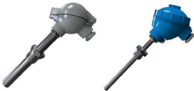
Компания ОВЕН выпустила на рынок новые модификации термопреобразователей с коммутационными головками с НСХ типа: ТХА (К), ТХК (L), ТНН (N) и ТЖК (J) в защитной арматуре (чехлах) из нержавеющей стали AISI 316Ti и AISI 310. Такие термопары работают в агрессивных средах гораздо дольше общепромышленных в чехлах из нержавеющей стали 12X18H10T.
