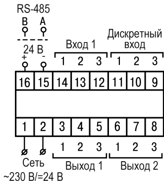
Рисунок 5.3 – Общая схема подключения ТРМ10–Щ5
