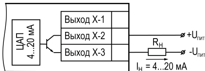
Рисунок 5.16 – Подключение к ВУ типа «И»
