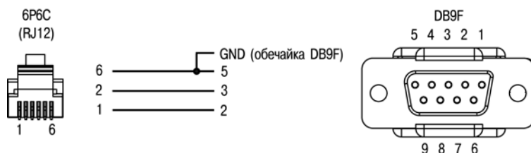
Рисунок В.2 – Схема кабеля KC2
