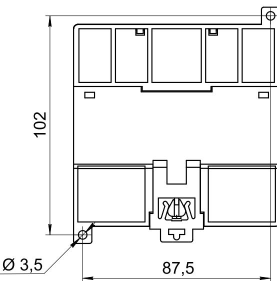
Рисунок 4.2 – Установочные размеры
