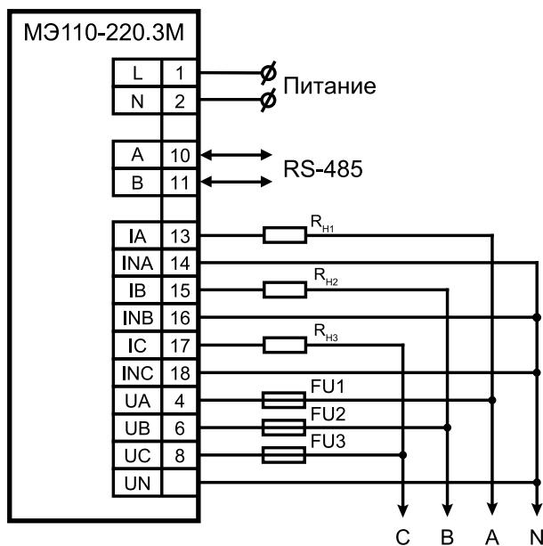
Рисунок 5.3 – Подключение прибора к трехфазной сети
