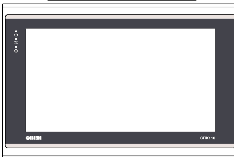
Рисунок 6.2 – Внешний вид лицевой панели: а) СПК107 [M01], б) СПК110 [M01]
