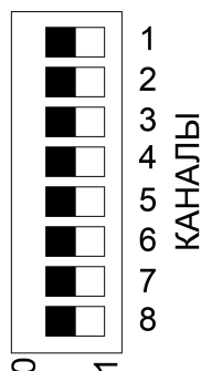
Рисунок 5.9 – DIP-переключатели на корпусе модуля для подключения резисторов
