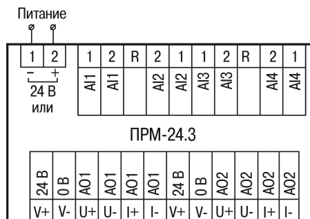
Рисунок 5.2 – Назначение контактов клеммника прибора с питанием 24 В
