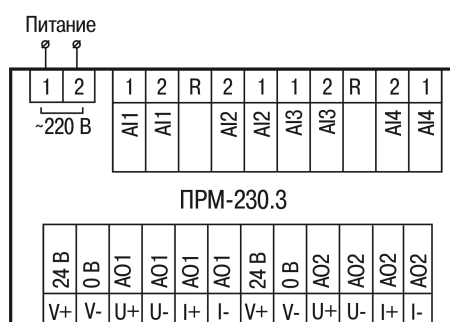
Рисунок 5.3 – Назначение контактов клеммника прибора с питанием 230 В
