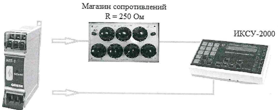
Рисунок Б.2 - Схема подключения выходных сигналов постоянного тока НПТ-1
