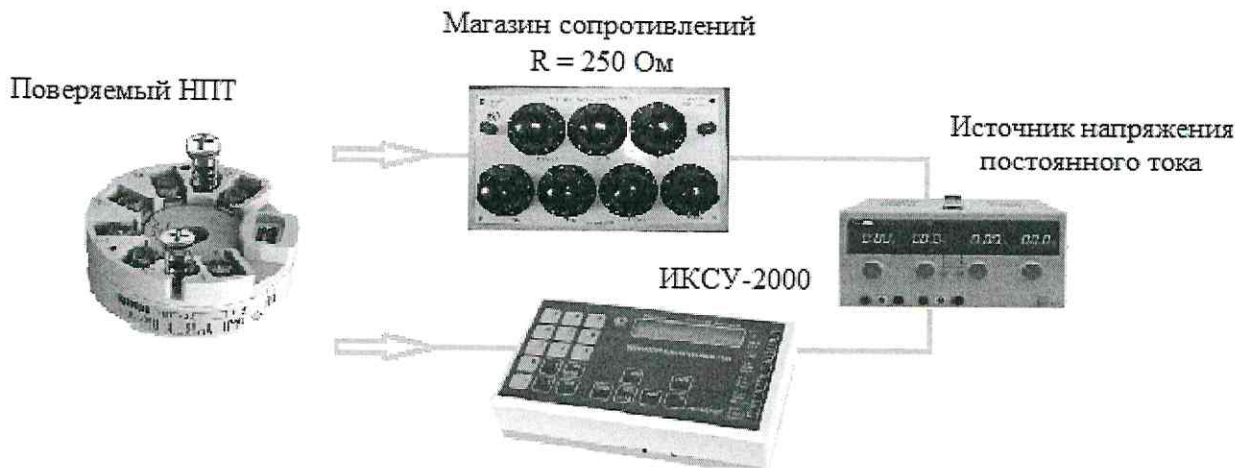
Рисунок Б.4 - Схема подключения выходных сигналов постоянного тока НПТ-2 и НПТ-3
