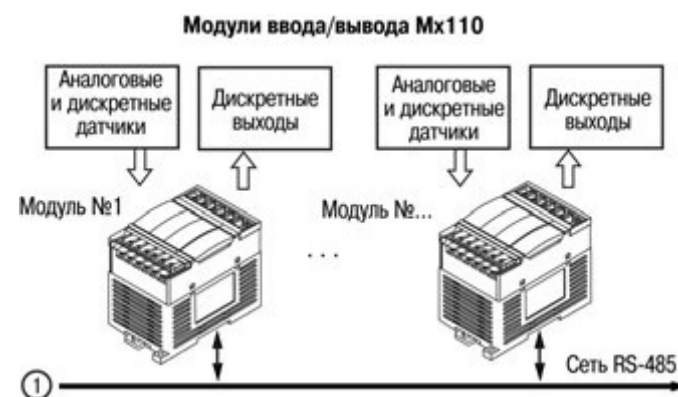
Рисунок 6.2 – Пример структуры соединений при использовании ПЛК323.ТЛ в системе управления (продолжение)
