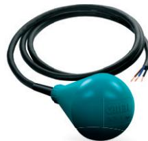
Подвесные сигнализаторы уровня ПСУ-1 предназначены для управления наполнением / опорожнением резервуаров жидкостями, неагрессивными к материалу датчика, в том числе содержащими твердые включения. ПСУ-1 имеют герметичный корпус из полипропилена с прочным гибким кабелем из неопрена длиной 5, 10 и 20 метров.
