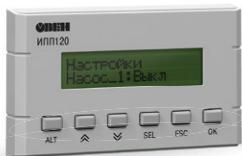
Начались продажи информационной программируемой символьной панели оператора с управляющей логикой ИПП120, которая предназначена для вывода и редактирования текстовых и цифровых параметров системы.
