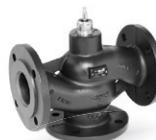
Начались продажи седельных клапанов BELIMO для плавного регулирования водяного потока в системах обработки воздуха и системах отопления, в закрытых системах холодной и горячей воды. Клапаны управляются стандартным сигналом =0...10 В электропривода или по 3-позиционной схеме. Равнопроцентная пропускная характеристика обеспечивается конструкцией конуса клапана.
