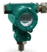
Расширен ассортимент преобразователей давления ОВЕН ПД100И моделями 115, 125, 175, 185 в полевом корпусе с ЖК-индикацией, перенастройкой диапазона и «нуля». Присоединительная резьба: M20×1,5, G1/2, G1/4, G1/2 «открытая мембра».
