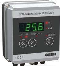
Прибор ОВЕН УЗС1 предназначен для ручного или автоматического управления исполнительными механизмами. В автоматическом режиме УЗС1 транслирует аналоговый сигнал от управляющего прибора или контроллера на исполнительный механизм, а в ручном – формирует сигнал 4...20 мА или 0...10 В, значение которого задается пользователем на лицевой панели.
