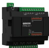
Модуль расширения ОВЕН ПРМ предназначен для увеличения количества входов и выходов (до 50 шт.) программируемого реле ОВЕН ПР200. К реле можно подключить до двух модулей по внутреннейшине. Входы, выходы и питание модуля гальванически развязаны относительно друг друга. Выпускаются две модификации с питанием ≈220 В (ПРМ-220.1) и =24 В (ПРМ-24.1).
