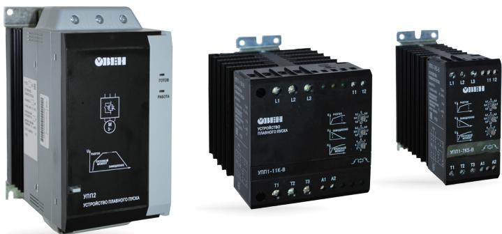
Сразу после запуска двигателя крутящий момент может достигать 150–200 %, а ток – 600–800 % от номинального, из-за чего в местной электросети могут возникать провалы и просадки напряжения. Для ограничения пускового момента, обеспечения плавного пуска и торможения асинхронных двигателей компания ОВЕН разработала серию устройств плавного пуска – УПП. Устройства предназначены для легкого и нормального режимов пуска и должны применяться совместно с устройствами
