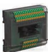
Для подключения дискретных входов/выходов рекомендуется применять выносной клеммный модуль ОВЕН ВКМ. Модуль устанавливается на DIN-рейку и позволяет подключить одну группу дискретных 16 входов/8 выходов контроллера СПК1xx.Д. Для подключения всех 72 точек ввода/вывода СПК1xx.Д потребуются три модуля. Модуль обеспечивает светодиодную индикацию работы входов/выходов, что упрощает пуско-наладочные работы. Цена модуля ВКМ (вкл. НДС): 1 239 руб.
