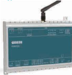
Программируемый контроллер ПЛК323-ТЛ предназначен для построения автоматизированных систем коммерческого (АСКУЭ) и технического (АСТУЭ) учета энергоресурсов, систем телеметрии, сбора и передачи данных, а также для объединения устройств с различными протоколами/интерфейсами связи в единую сеть.
