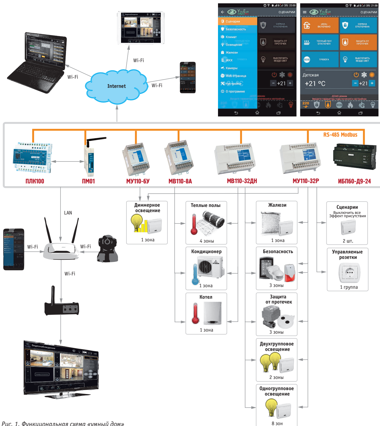
Рис. 1. Функциональная схема «умный дом»
