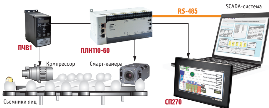
Рис. 1. Функциональная схема сортировки яиц
