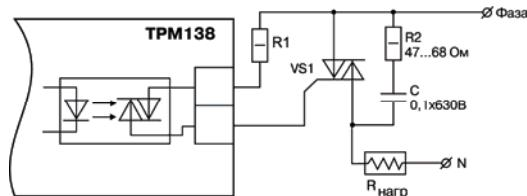
**Рисунок 3.15 – Использование симисторной оптопары для управления силовым симистором**
