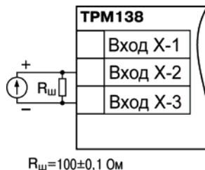
**Рисунок 3.4 – Схема подключения датчика с токовым выходом**
