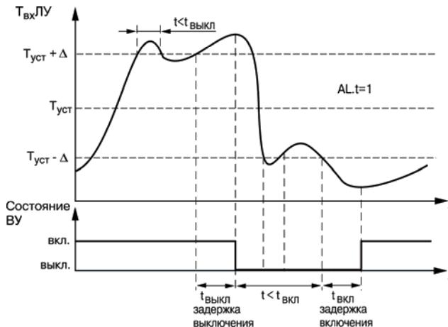
Рисунок 3.10 – Работа ЛУ с задержками включения и выключения
