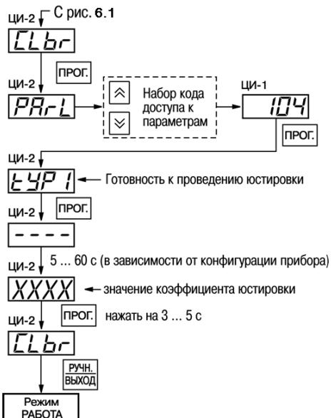
**Рисунок Д.2 – Схема проведения юстировки прибора для работы с первичным
