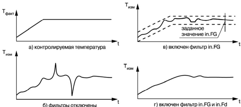
Рисунок 3.5 – Временные диаграммы работы цифровых фильтров
