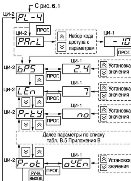
Рисунок 7.6 – Схема установки программируемых параметров на уровне PL-4
