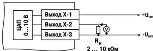
Рисунок 3.19 – Пример подключения выходного устройства типа «У»
