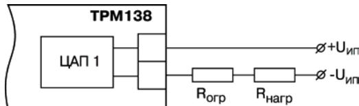
Рисунок 3.17 – Схема соединения ЦАП с нагрузкой
