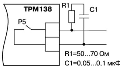
**Рисунок 3.13 – Шунтируование контактов реле при работе с индивидуальными нагрузками**
