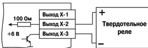
Рисунок 3.18 – Использование транзисторного ключа для управления твердотельным реле
