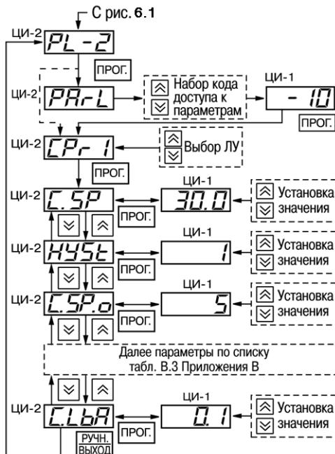
**Рисунок 7.4 – Схема установки программируемых параметров на уровне PL-2**
