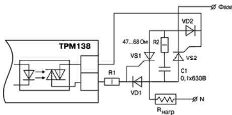
**Рисунок 3.16 – Использование симисторной оптопары для управления силовыми тиристорами**
