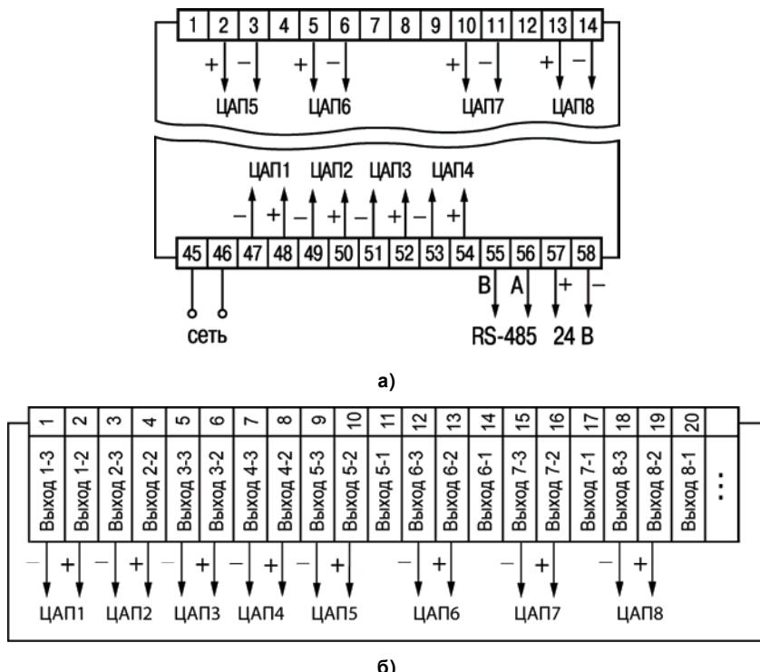
**Рисунок Б.5 – Схема подключения ЦАП прибора ТРМ 138-И:
