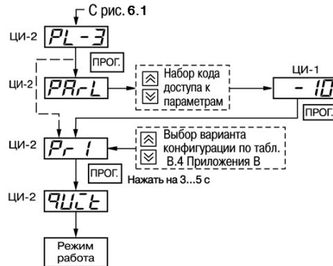
Рисунок 7.5 – Схема установки программируемых параметров на уровне PL-3
