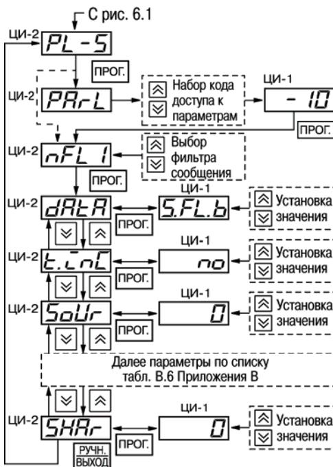
**Рисунок 7.7 – Схема установки программируемых параметров на уровне PL-5**
