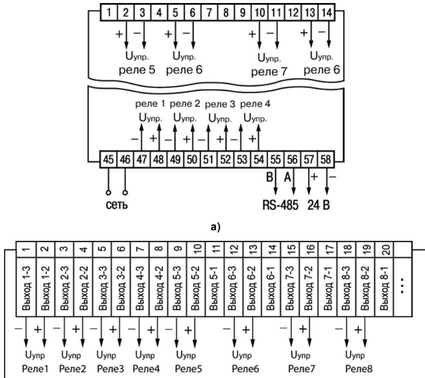
**Рисунок Б.6 – Схема подключения твердотельных реле прибора TPM 138-Т: а) в корпусе Щ4, б) в корпусе Щ7**
