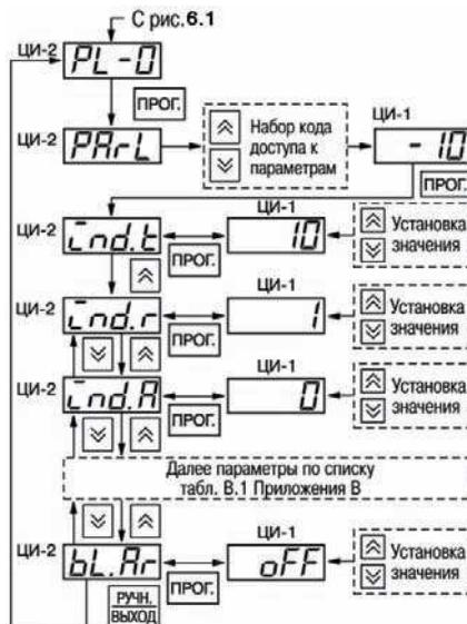
Рисунок 7.2 – Схема установки программируемых параметров на уровне **PL-0**
