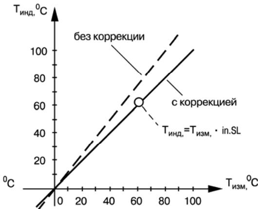
**Рисунок 3.7 – Коррекция «наклон характеристики»**
