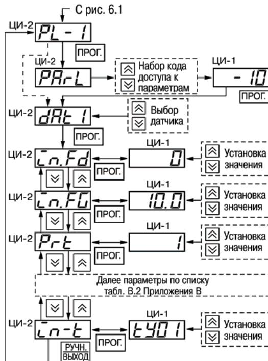
**Рисунок 7.3 – Схема установки программируемых параметров на уровне PL-1**
