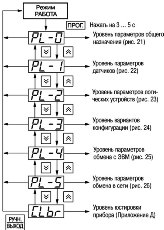
Рисунок 6.1 – Схема выбора уровня программируемых параметров
