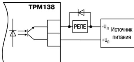
**Рисунок 3.14 – Использование транзисторной оптопары для управления реле**
