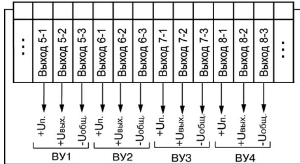
**Рисунок Б.7 – Схема подключения выходных устройств прибора TPM 138-У**
