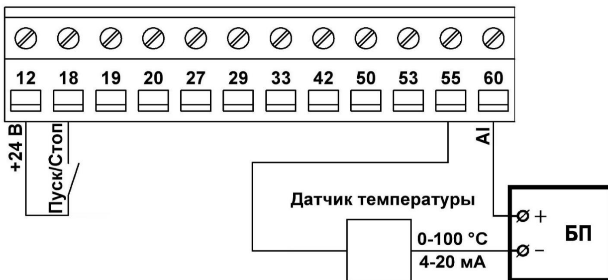
Рисунок 2. Схема подключения датчика температуры к ПЧВ и использованием внешнего источника питания.
