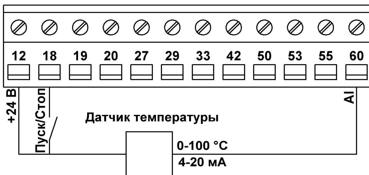
Рисунок 1. Схема подключения датчика температуры к ПЧВ и использованием внутреннего источника питания.
