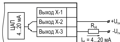
Рисунок 5.26 – Подключение к ВУ типа «И»
