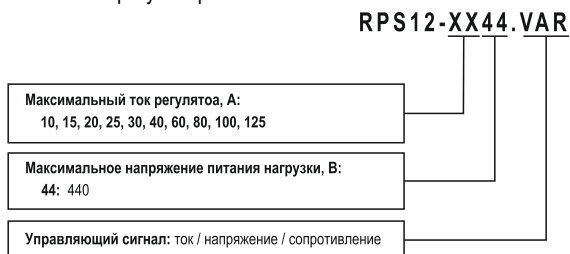
Рисунок 1 - расшифровка условного обозначения регуляторов KIPPRIBOR RPS12
