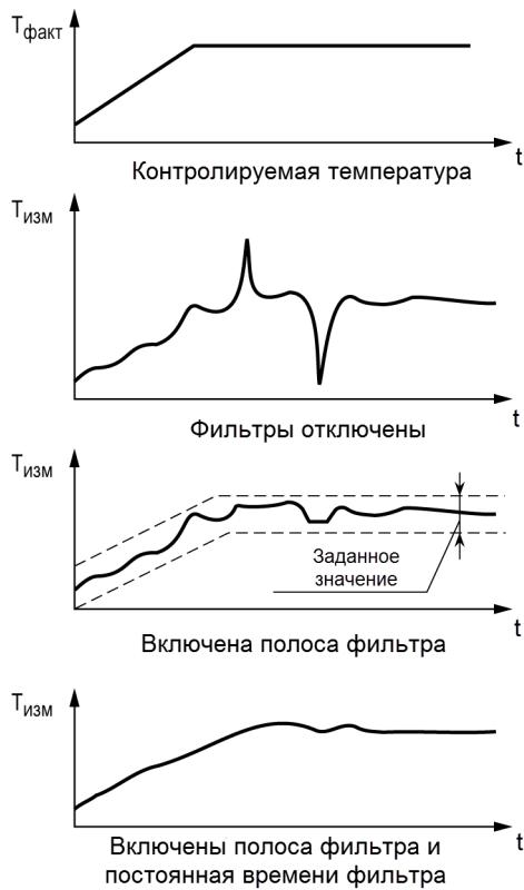
**Рисунок 5.19 – Временные диаграммы работы цифровых фильтров**
