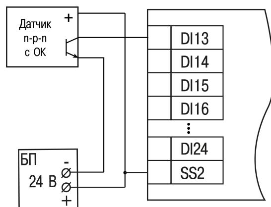
Рисунок 5.10 – Подключение транзисторов типа n-p-n к дискретным входам DI13–DI24
