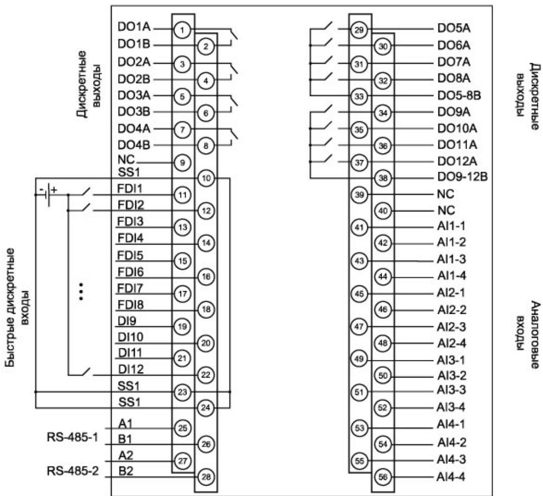
Рисунок 5.4 – Назначение контактов клеммника (модификация 14)
