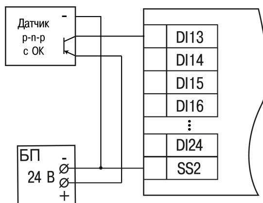
Рисунок 5.9 – Подключение транзисторов типа p-n-p с ОК к дискретным входам DI13–DI24
