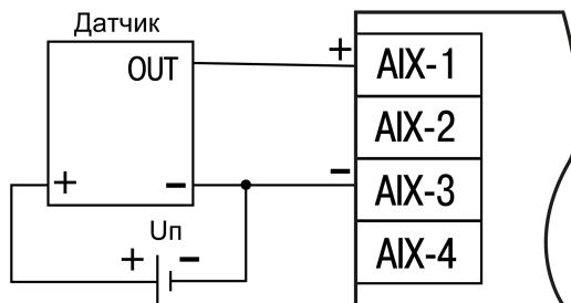
**Рисунок 5.14 – Схема подключения датчиков с унифицированным выходным сигналом  $-50\dots+50$  мВ и  $-1\dots+1$  В по трехпроводной схеме**
