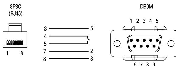
**Рисунок 5.26 – Схема кабеля KC17**
