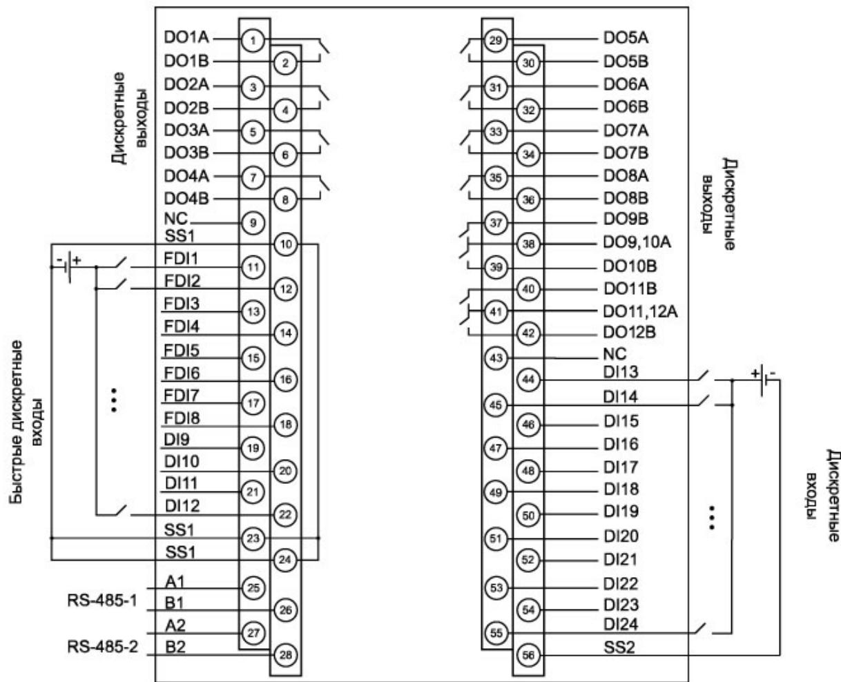
Рисунок 5.3 – Назначение контактов клеммника (модификация 12)
